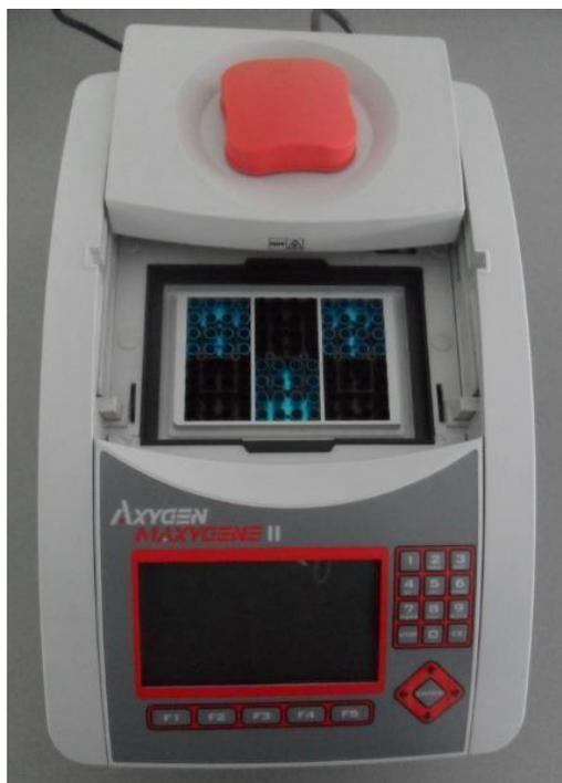
Imagen 8.7. Termociclador utilizado en proceso de amplificación del ADN utilizando el método de reacción en cadena de la polimerasa (PCR). Cortesía del CIGGUR, Bogotá, Colombia.
