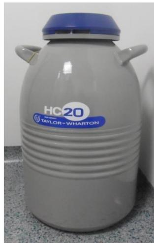
Imagen 6.1. Contenedor de nitrógeno líquido, permite una temperatura cercana a  $190^{\circ}\text{C}$  bajo cero.
