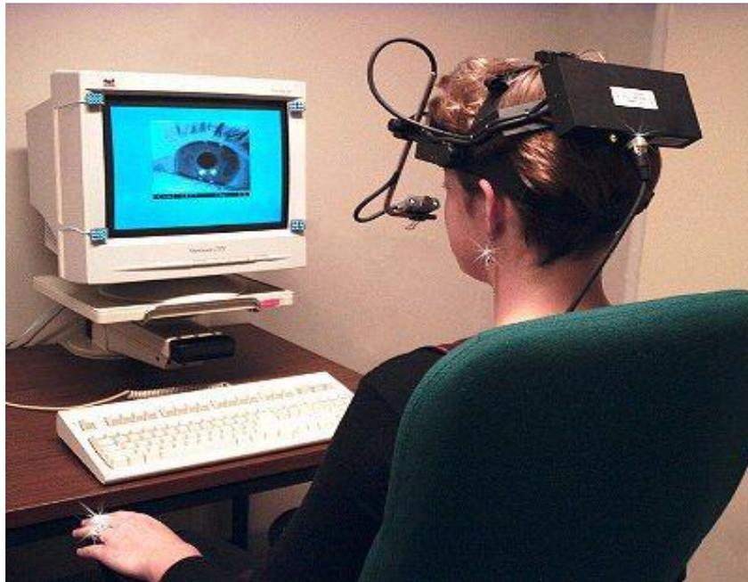
*Figura 7.* Equipo para eye-tracking. Tomado de <http://hazmerca.com/2011/04/08/el-eye-tracking-en-neuromarketing/>
