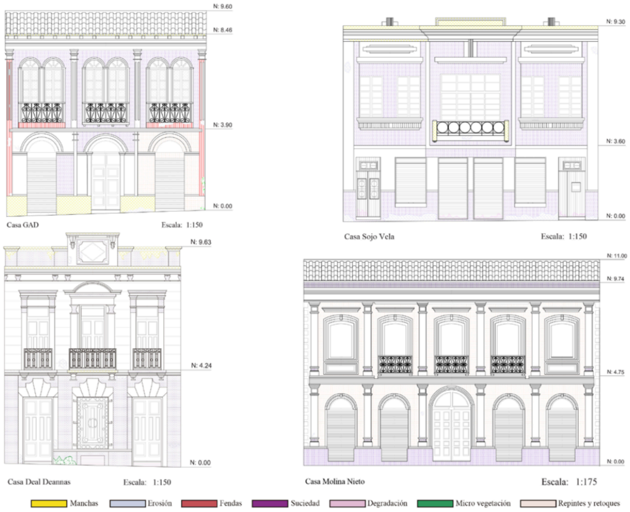
Figura 4. Fachadas y lesiones patológicas de los puntos de control
