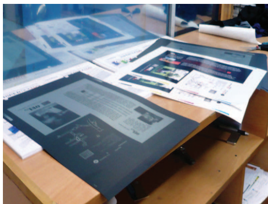
Foto Johana Acevedo Camacho. El uso de planchas de impresión es muy cotidiano en técnicas como la flexografía, muy conocida en el parque. Sin embargo, este proceso incrementa costos debido a la elaboración de dicha plancha, antiguamente de metal y ahora de papel, por lo cual no es viable en la elaboración de pequeños volúmenes.
