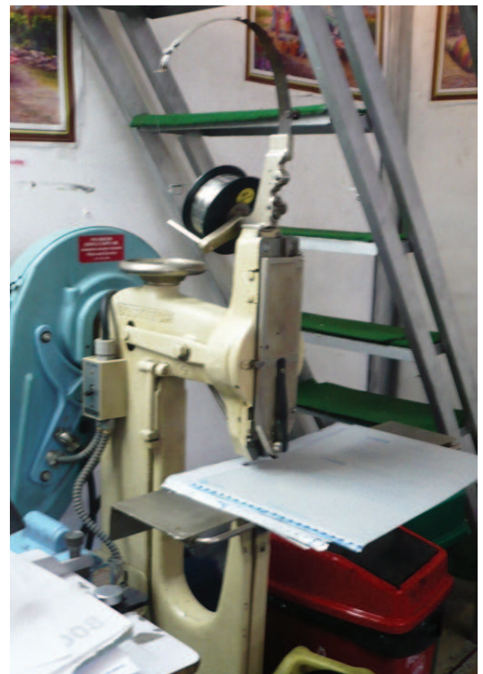
Foto Johana Acevedo Camacho. Máquina empleada para grapar hojas.
