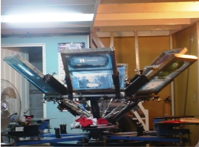
Foto Johana Acevedo Camacho. Pulpo mecánico de 6 colores y 4 mesas, empleado para trabajar fotoscreen.
