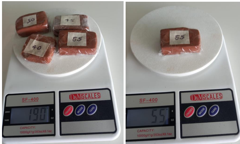
Figura 16. Bloques de arcilla para prueba de peso
