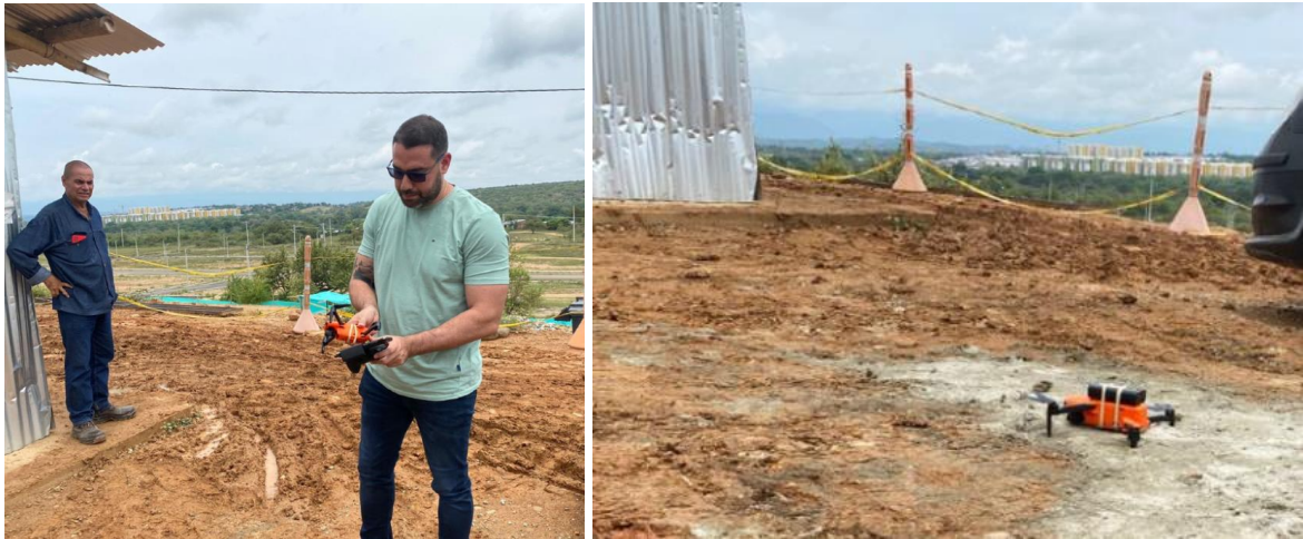
Figura 33. Actividades de uso del Dron con sensor adaptado para la medición de calidad del aire en zona de estudio.
