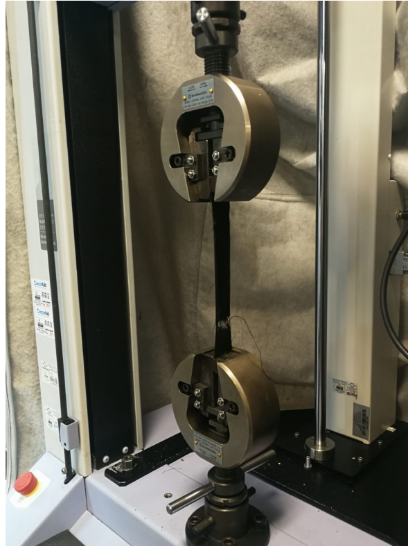
Figura 4.9: Imagen tomada en el ensayo de tensión, donde se puede observar el fallo de la probeta correspondiente al material textil negro.
