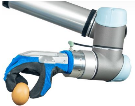
Figura 2.7: Mano robótica qb Soft Hand , desarrollada por la empresa qb robotics , implementando tecnología suave y tecnología rígida [47].
