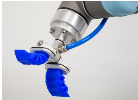
Figura 2.8: Pinza robótica para mecanismos industriales automatizados qb Soft Hand [47].
