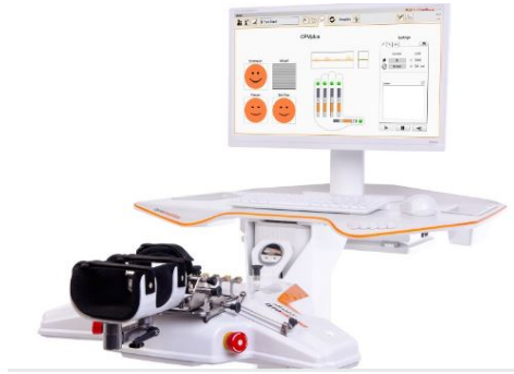
Figura 2.4: Robot AMADEO desarrollado por Tyromotor [35], para terapias de asistencia en rehabilitación de miembro superior.
