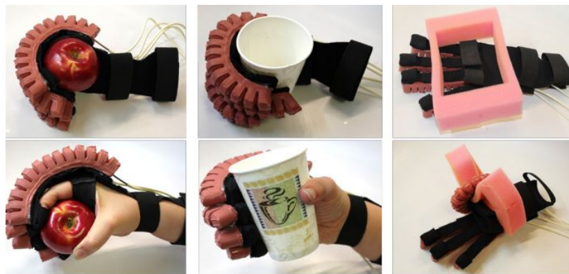
Figura 2.12: Actuador PneuNet en una aplicación para asistencia en guante de rehabilitación [54].
