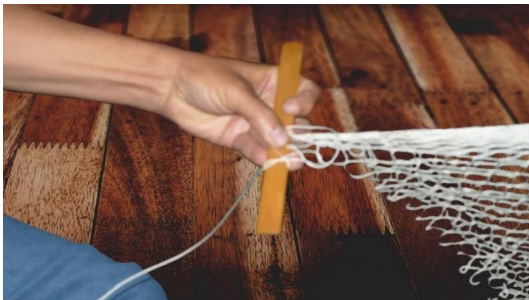
Figura 3.10. Configuración de la mano izquierda para asir la pala
