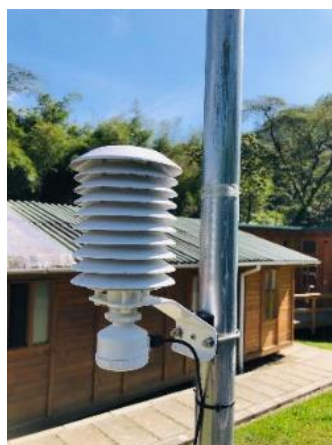
Ilustración 8. Termohigrómetro y Albedómetro Clase A. Fuente: Elaboración propia
