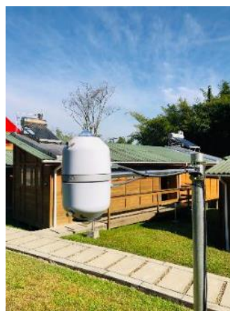
Ilustración 8. Termohigrómetro y Albedómetro Clase A. Fuente: Elaboración propia
