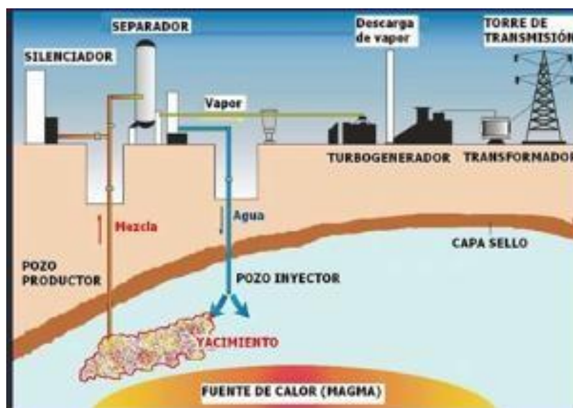
Figura 7. Facilidades de una central Geotérmica
