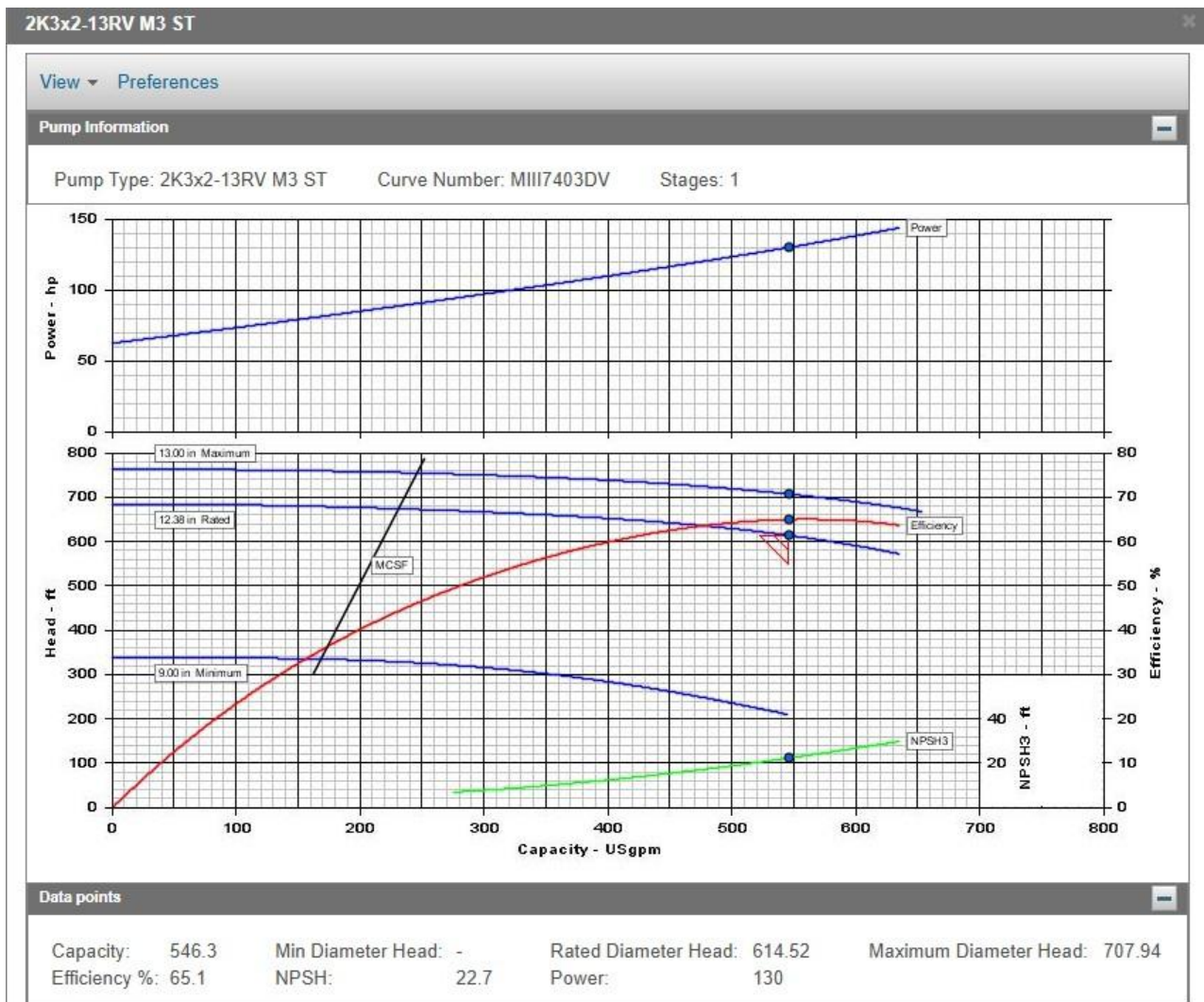
Figura 55. Curva de desempeño de bomba seleccionada Fuente: (Flowserve, 2021).
