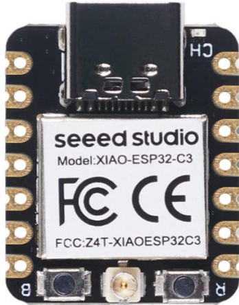
Figura 7. Placa utilizada en dispositivo de IoT. Placa Seeed Studio XIAO ESP32C3
