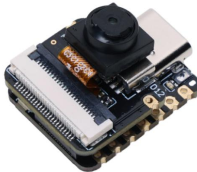
Figura 8. Instrumento de recolección para el modelo de IA. XIAO ESP32S3 Sense
