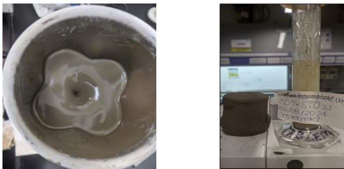
Figura 14. Prueba de Mezclabilidad y Filtrado HTHP – 50% Sílice
