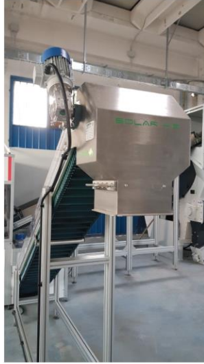
Figura 9, Modelo de Cinta transportadora para descarga de vidrio [40].
