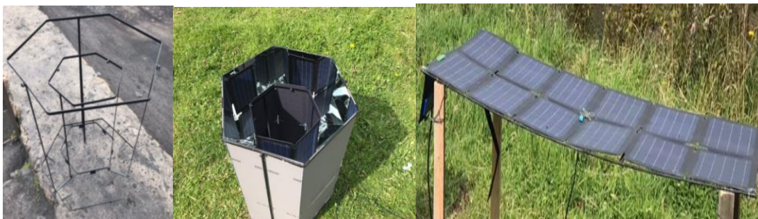
Figura 14. hexágono en construcción y montaje (panel 2) y panel plano (panel 1)
