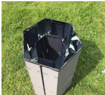
Figura 8. Arreglo Hexagonal de Panel 2
