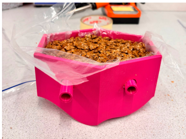
Figura 5 Molde 2 relleno con biocompuesto del hongo Ganoderma Lucidum , con un plástico en la base para facilitar su desmolde (13 de marzo).
