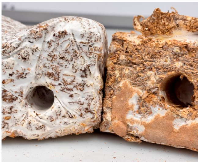
Figura 16 Vista frontal del bloque 1 junto al bloque 2, evidencia de la pérdida de agua en el bloque 1.
