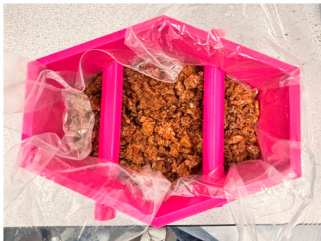
Figura 4 Proceso del relleno del molde 2, con la estructura interna para que el hongo crezca con los orificios preestablecidos del diseño.
