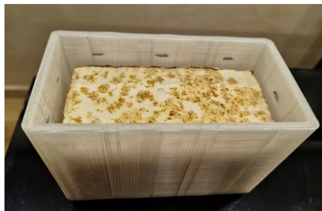
Figura 31 Bloque 4 después de pasar por la deshidratadora, se evidencia la diferencia de tamaño respecto a las líneas marcadas en el molde, las cuales indican la medida antes de ser horneado.
