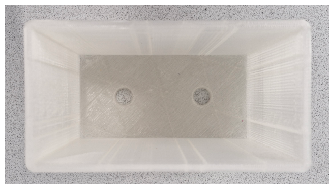
Figura 8 Molde 4 impreso en 3D, de base rectangular, con orificios para facilitar su desmolde y tapa en la parte superior que funciona como prensa del sustrato.
