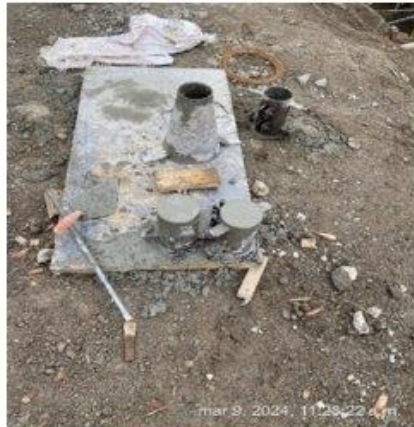
Cilindros para pruebas de resistencia de concreto a compresión
