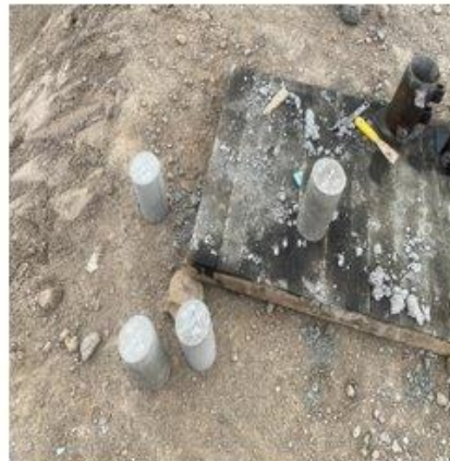
Cilindros para pruebas de resistencia de concreto a compresión
