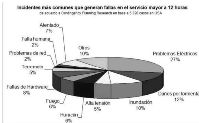
Fig8. Incidentes más comunes que generan fallas en el servicio de un data center.
