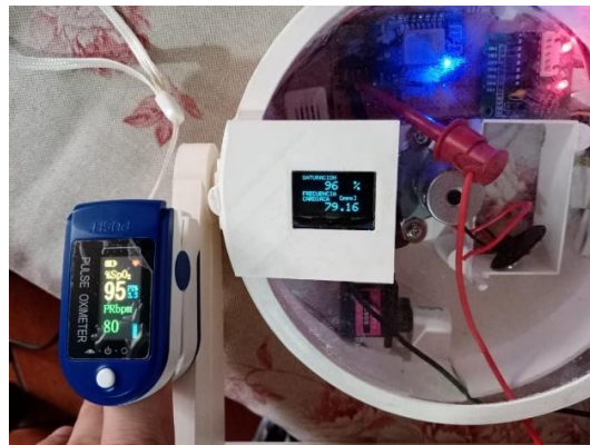
Figura 37. Comparación de medidas entre sensor MAX30100 y sensor comercial. Fuente propia.
