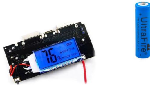
Figura 16. modulo DC-DC y batería de litio.
