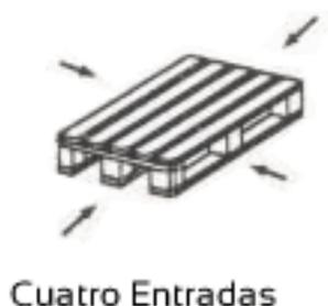
**Figura 34.** Estiba de madera cuatro entradas.
