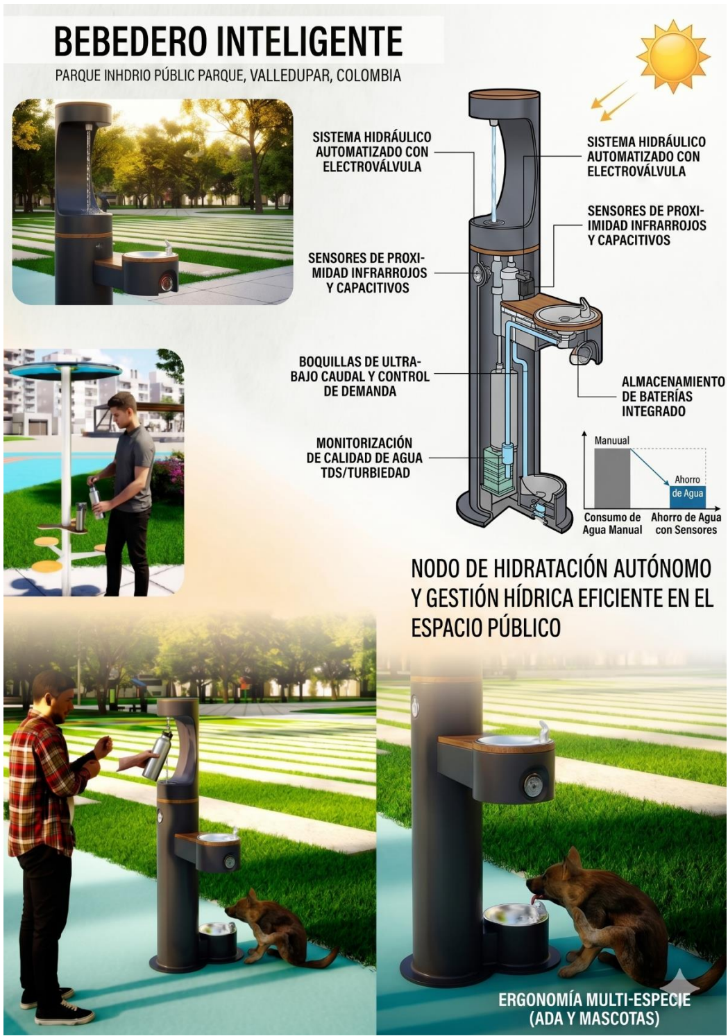
Fig. 86 Bebedero inteligente con sensores
