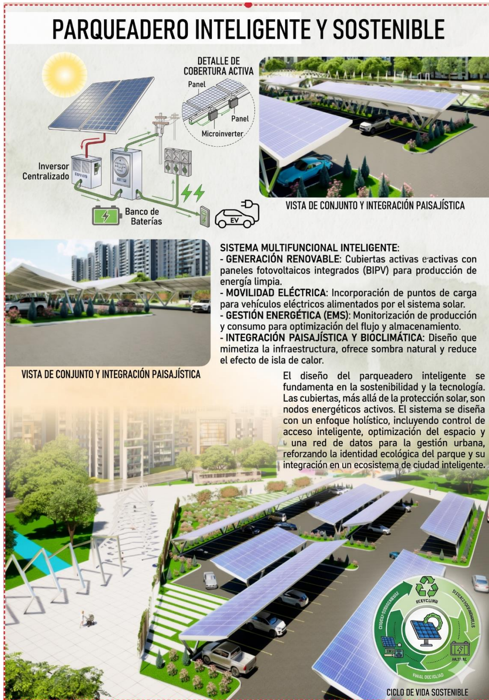
Fig. 68 Parqueadero con Cubierta Fotovoltaica
