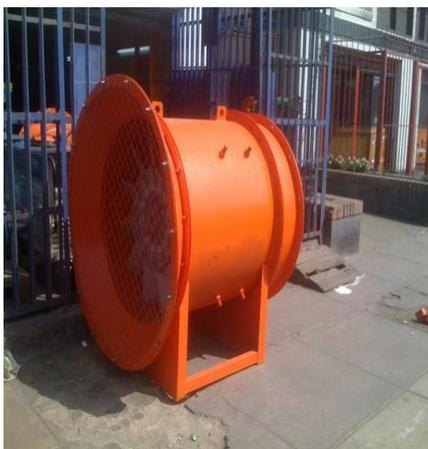
**SUCCIONADOR DE SALVADO:** máquina que se encarga de succionar el salvado de maíz mediante un ventilador.
