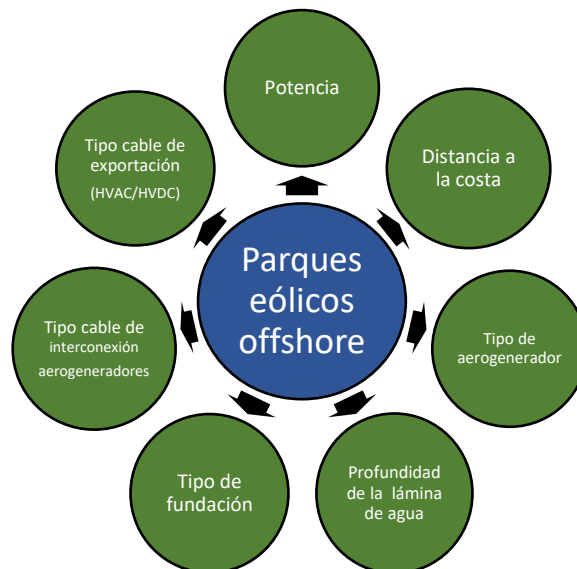
Figura 21. Principales parámetros de ingeniería para parques eólicos Offshore. Adaptación[25]
