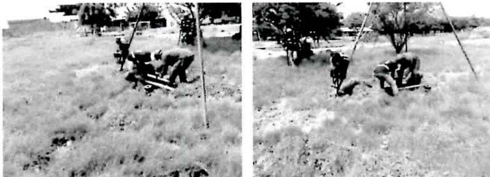
Sondeo 5. Profundización final con barreno
