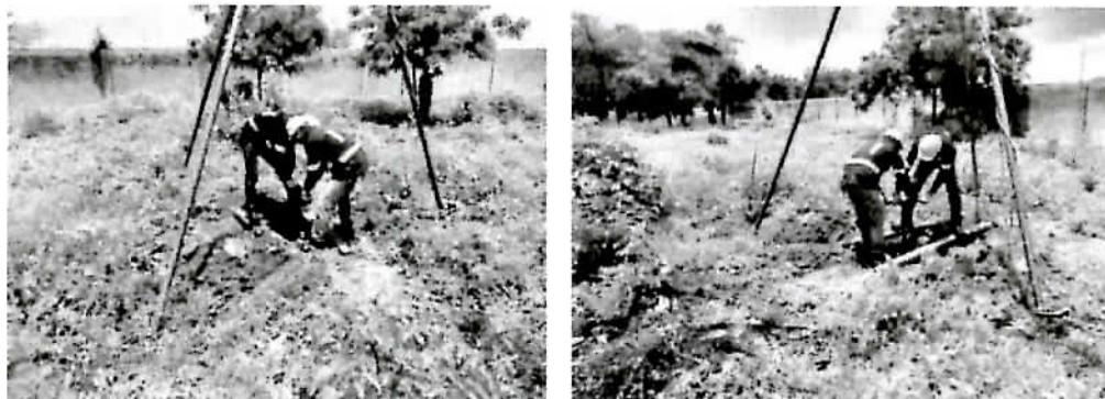
Sondeo 3. Profundización final con barreno
