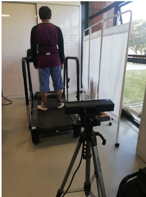
Figura 3.4: Ubicación del sensor kinect respecto a la banda sin fin
