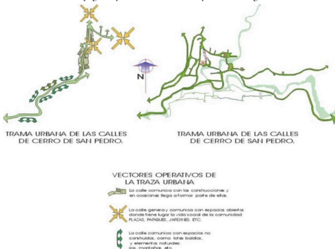
Figura 3. Esquemas de organización de caminos y traza urbana de acuerdo con la topografía y los intereses sobre los yacimientos argentíferos
