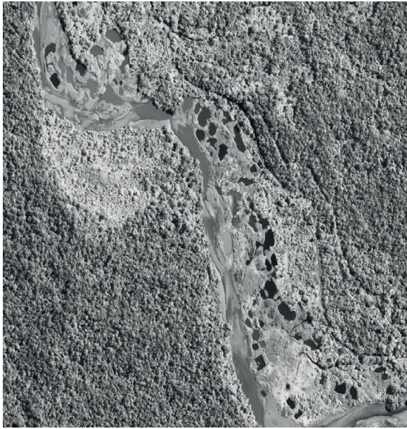
Figura 1. Vista de detalle del río Dagua afectado por excavaciones de su cauce activo y lecho mayor por minería ilícita de oro aluvial
