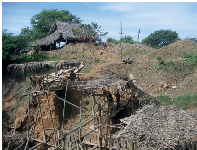
Fotografía 1. Ejemplo de la forma de trabajo en minería sobre saprolitos 3 y coluviones, por pequeños mineros y barequeros, lo que es semejante en cualquier lugar del mundo. San Martín de Loba, Bolívar
