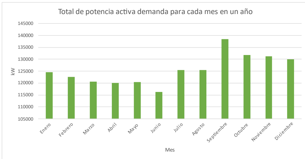
Ilustración 8. Potencia total activa demandada en Leticia para cada mes en un año. Fuente elaboración propia
