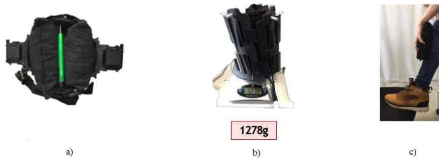
Figura 7.2: Interfaz física actual del T-Flex. a) Tamaño actual de la interfaz. b) Peso actual de la interfaz. c) Poca adherencia.
