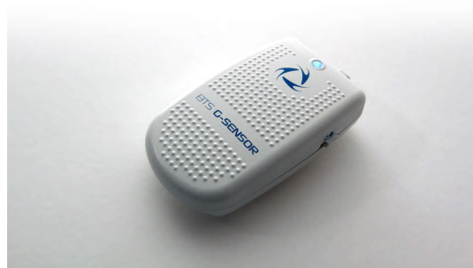
Figura 2.9: Sensor inercial G-Walk para medir parámetros espacio-temporales de la marcha
