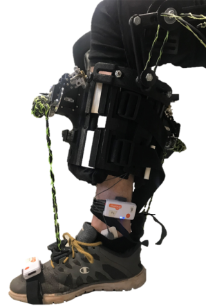
(b) Ortesis robótica de tobillo T-Flex
