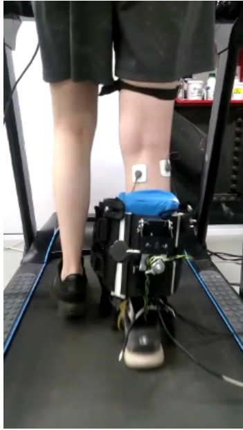
Figura 4.1: En la figura se puede apreciar como el T-Flex (con interfaz de (2cm 80/20)) se encuentra más abajo de su posición natural.
