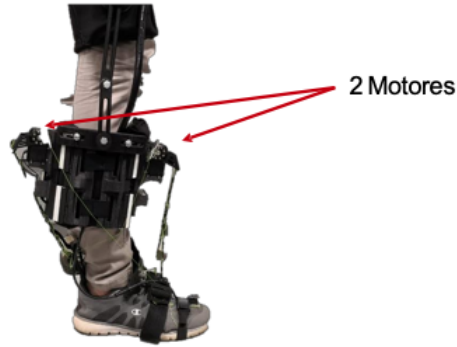
Figura 7.1: Órtesis activa de tobillo T-Flex, con la que se realizarán las pruebas descritas.
