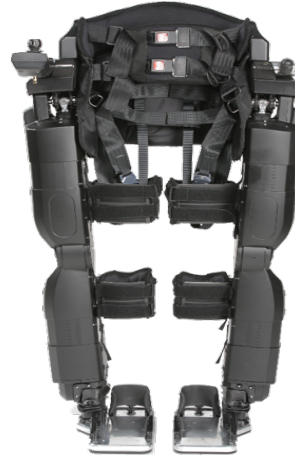
(b) Exoesqueleto de miembros inferiores Rex.
