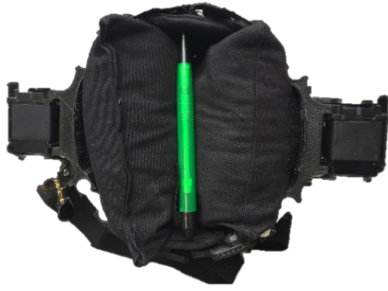
(a) Tamaño de la interfaz actual del T-Flex de dimensiones 10cm x 5cm
