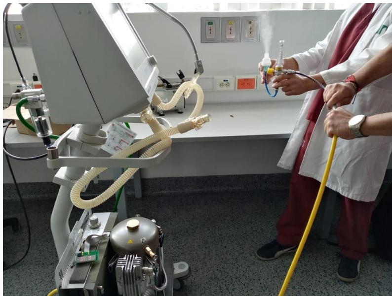
*Figura 10: Montaje para nebulización con compresor de aire de ventilador mecánico fuente el autor (pruebas realizadas en el laboratorio de ingeniería clínica- escuela de medicina y ciencias de la salud – universidad del Rosario- programa de ingeniería biomédica.*
