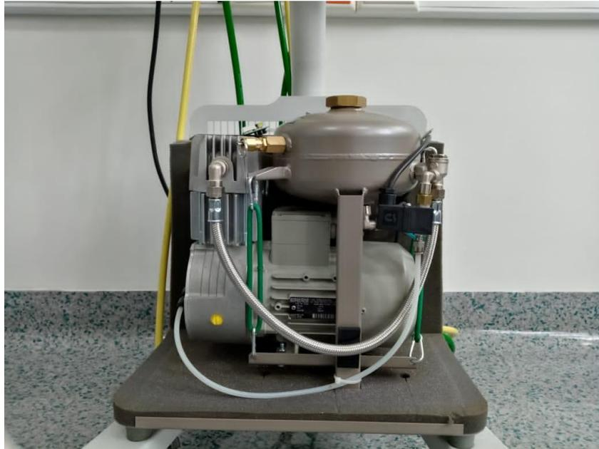
*Figura 6: compresor de aire del ventilador mecánico neumovent utilizado para las pruebas de nebulización fuente el autor (pruebas realizadas en el laboratorio de ingeniería clínica- escuela de medicina y ciencias de la salud – universidad del Rosario- programa de ingeniería biomédica.*
