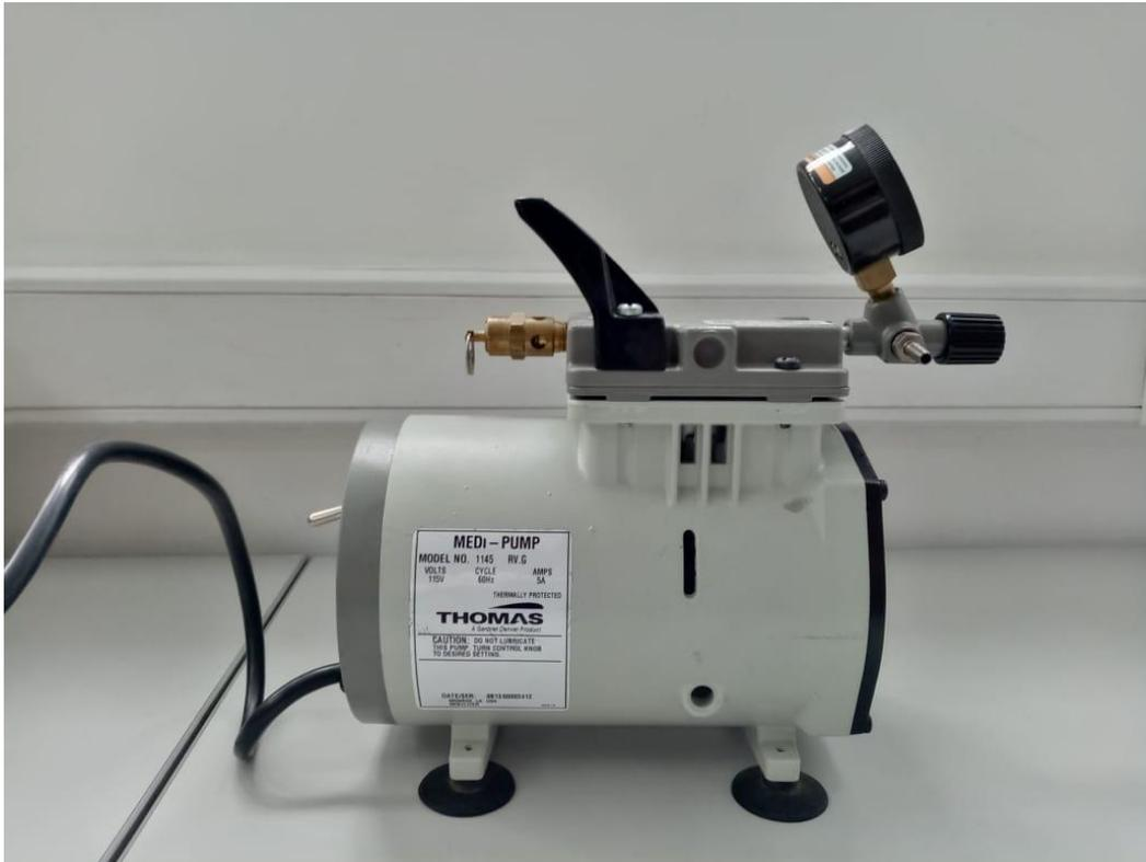
*Figura 13: Compresor de aire usado para las primeras 2 pruebas de nebulización fuente el autor (pruebas realizadas en el laboratorio de ingeniería clínica- escuela de medicina y ciencias de la salud – universidad del Rosario- programa de ingeniería biomédica.*
