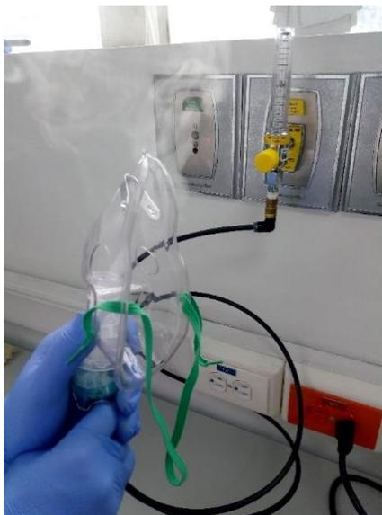
*Figura 16: Prueba de nebulización con mascarilla y el sistema de gases fuente el autor (pruebas realizadas en el laboratorio de ingeniería clínica- escuela de medicina y ciencias de la salud – universidad del Rosario- programa de ingeniería biomédica.*
