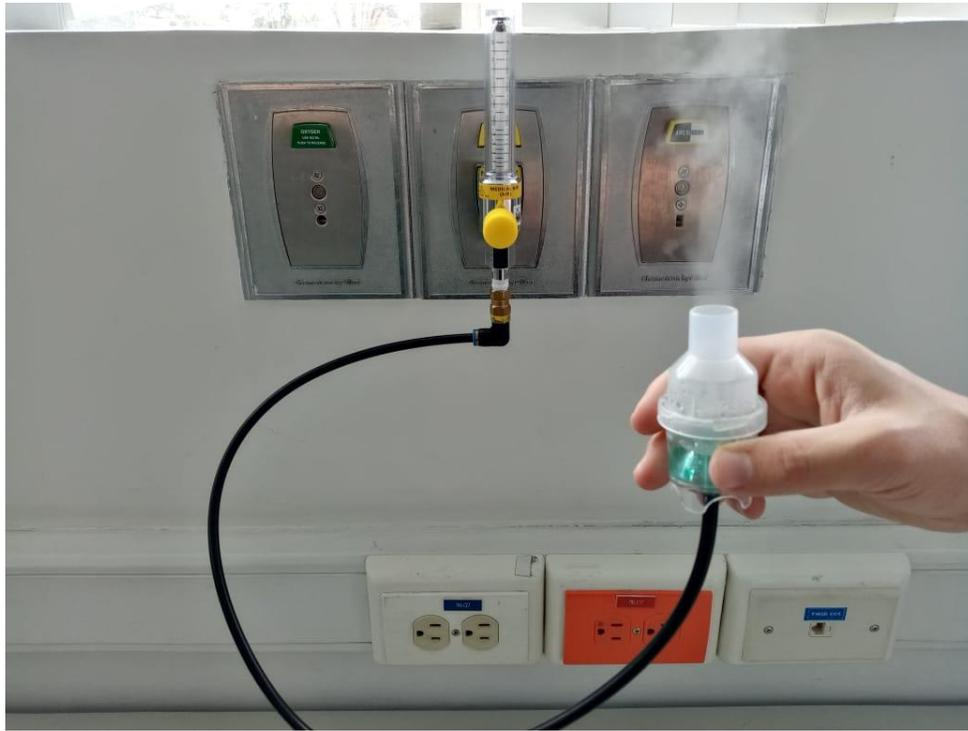
*Figura 8: montaje de nebulización usando la red de gases medicinales fuente el autor (pruebas realizadas en el laboratorio de ingeniería clínica- escuela de medicina y ciencias de la salud – universidad del Rosario- programa de ingeniería biomédica.*
