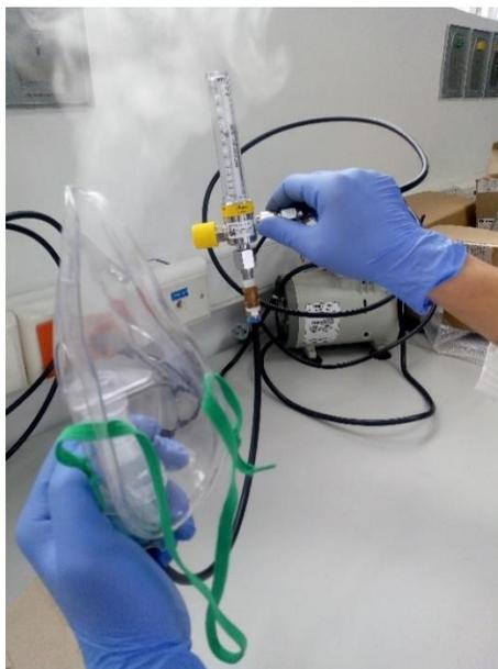
*Figura 17: Prueba de nebulización con mascarilla y el compresor de aire fuente el autor (pruebas realizadas en el laboratorio de ingeniería clínica- escuela de medicina y ciencias de la salud – universidad del Rosario- programa de ingeniería biomédica.*
