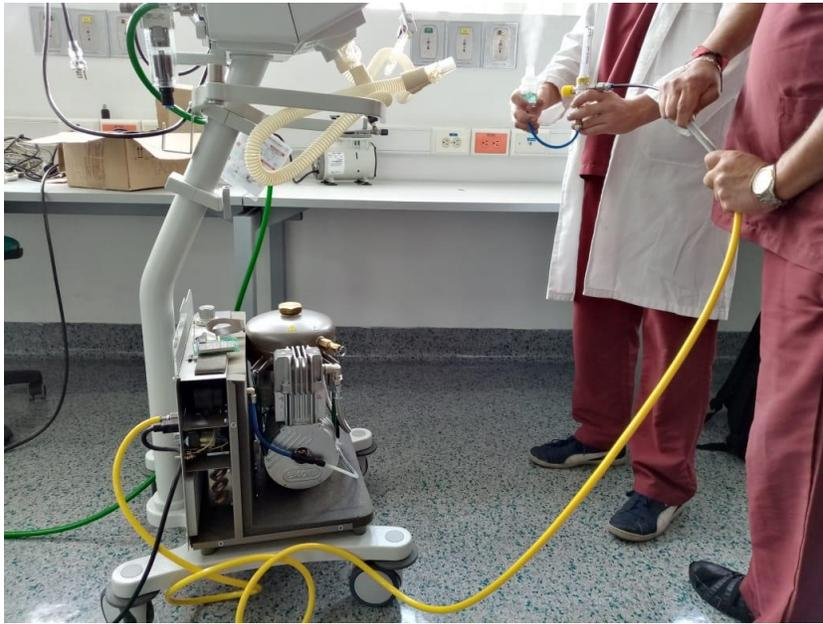
*Figura 9: Montaje para nebulización con compresor de aire de ventilador mecánico fuente el autor (pruebas realizadas en el laboratorio de ingeniería clínica- escuela de medicina y ciencias de la salud – universidad del Rosario- programa de ingeniería biomédica.*
