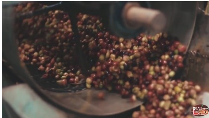
Figura 1. Fase de despulpado del café en un beneficiadero ecológico
