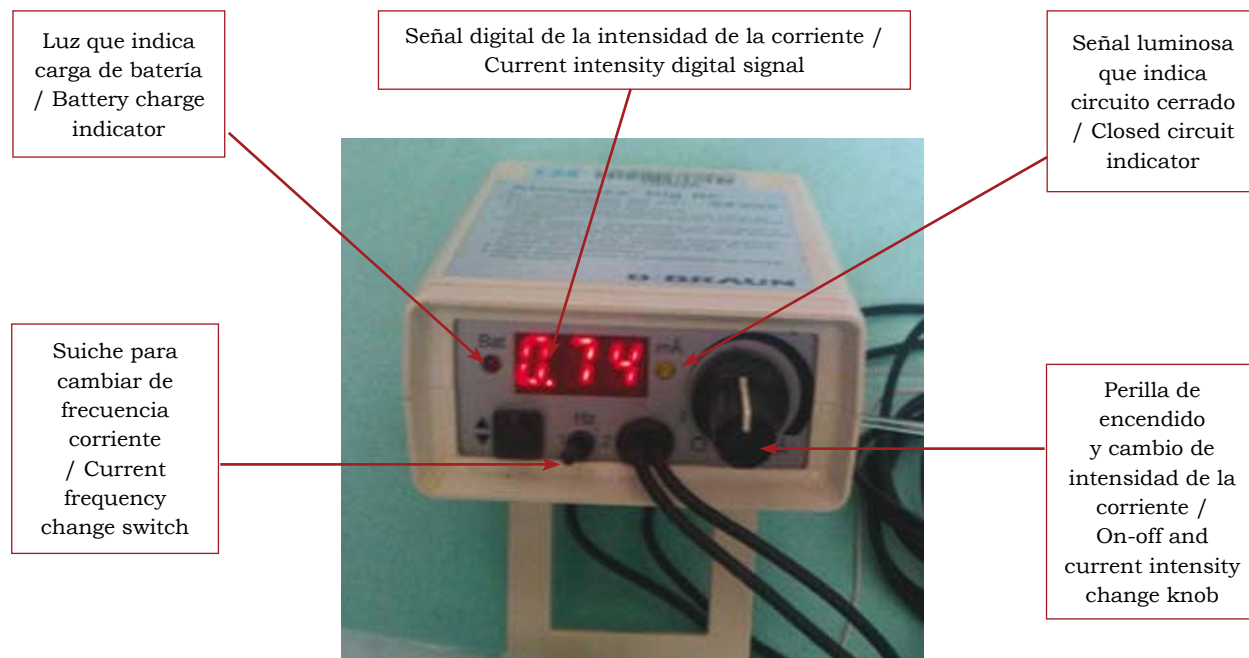
Figura 1. Neuroestimulador de nervio periférico
