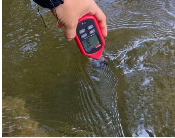
Figura 31. Medición de velocidad (m/s - Anemómetro)
