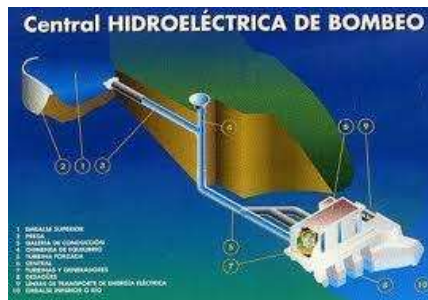
Figura 15. PCH de Bombeo [26]
