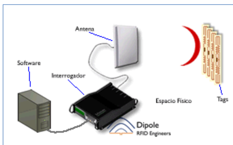
Figura 1. Forma de trabajar tecnología RFID. Fuente: ( http://rfidenmexico.blogspot.mx marzo 2013)
