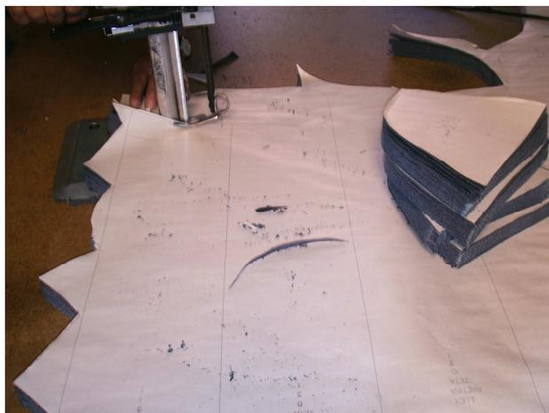
Gráfica 16. Cortador extrayendo las piezas del trazo del modelo con la máquina cortadora. Propiedad del autor.
