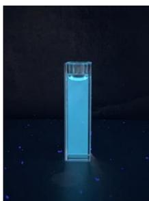
Figura 10. Solución resultante de la síntesis de los puntos de carbono (ácido cítrico, etanol y dimetilformamida) bajo radiación con luz UV ( $\lambda_{exc} = 365$  nm).
