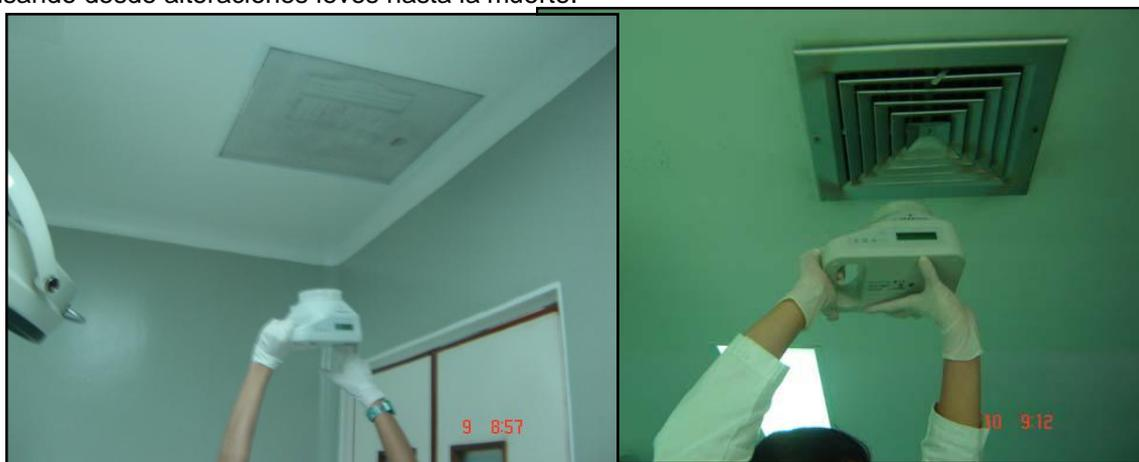
**Figura 7. Muestreo de aire-Sistemas de Climatización**
