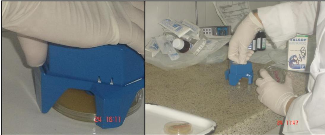
**Figura 28. Muestreo de superficie antes de la desinfección**
