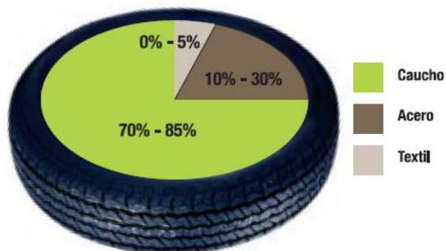
**Figura 1:** porcentaje en peso de los componentes de una llanta
