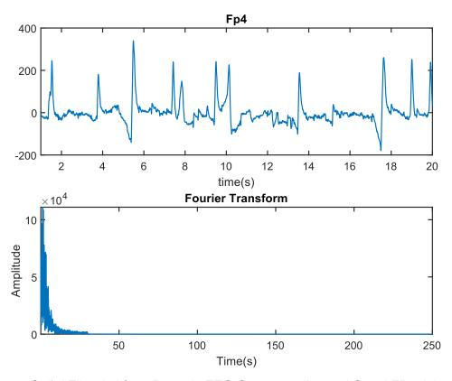
Figura 6. Señal Filtrada Línea Base de EEG Correspondiente al Canal FP4 del sujeto 23 y su Espectro en Frecuencia
